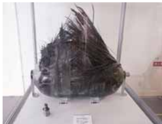
センターに展示されているアルミライナー複合容器の水圧破裂試験サンプル
